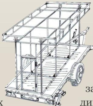
під використання рекламних та презентаційних урахуванням вітрових навантажень на рекламну зварну об'ємну сталеву конструкцію рамного типу з лонжеронами, дишель V-подібної конструкції жорстко в декількох місцях з посиленням косинками. Знімні до рами причепа через болтові з'єднання підвищеної забезпечує надійну та безпечну експлуатацію причепа з динамічних і статичних навантажень. Причепа мають з
