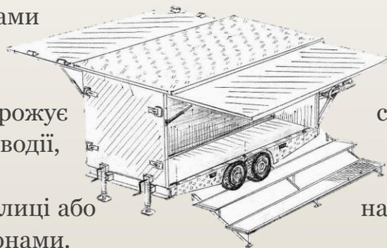
❑ **Конструкція причепа** конструкцій, розрахована з площину, представляє собою поздовжніми і поперечними приварюється до рами рекламні конструкції кріпляться міцності. Така конструкція рекламними носіями при різних боків допоміжні технологічні площадки, які необхідні для зручного обслуговування рекламних поверхонь.
